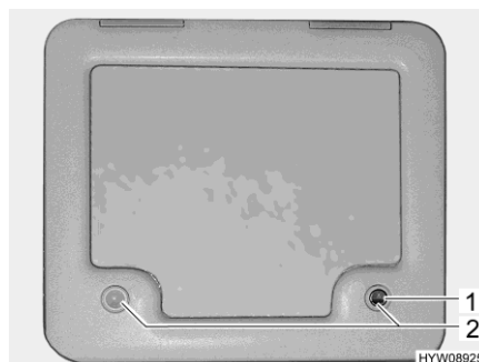
Bild 105 Lucka för latrintanken
