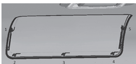
Fig. 28: Indersiden af det hvælvede hængselvindue med fem vridere
