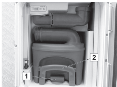
Fig. 199: Toilettank i tømmeskakten
