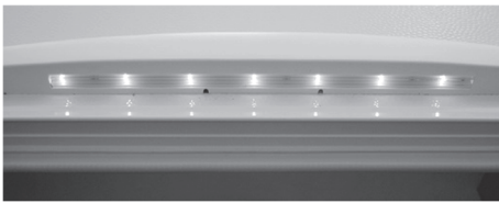
Fig. 68: Forteltlampe med lysdioder
