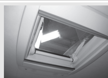
Fig. 33: Tagluge 400 x 400 mm VisionStar 700 x 500 mm
