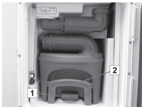
Fig. 172: Toilettank i tømmeskakten
