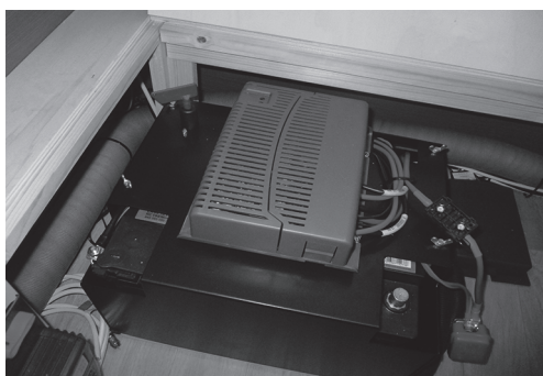
Fig. 63: Batteriafdækning med styreenhed til Mover (ekstraudstyr)
