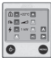
Fig. 138: Betjeningsenhed i indstillingsmenu
