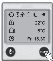
Fig. 137: Betjeningsenhed i hvilestilling
