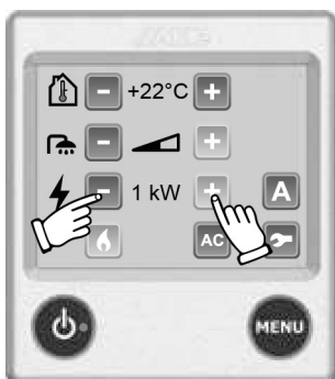
Afb. 150: Verwarmen met stroom
