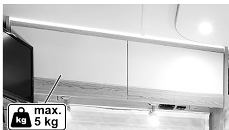
Afb. 52: Hangkasten in het woongedeelte
