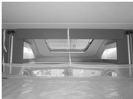
Afb. 171: Neergelaten hefbed met valbescherming
