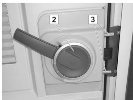
Afb. 17: Deur gesloten en geborgd
