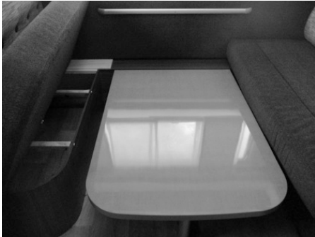
Afb. 182: Tafel ingehangen in de onderste rail.
