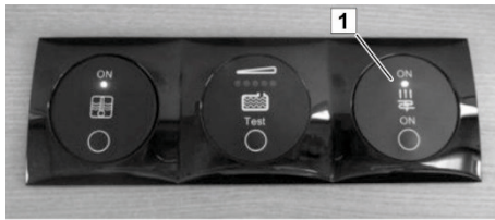
Afb. 130: Aan/uit-schakelaar van de vloerverwarming
