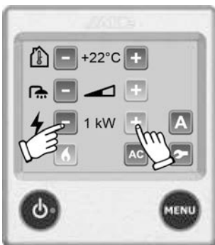
Afb. 163: Verwarmen met stroom
