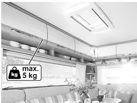
Afb. 51: Hangkasten in het woongedeelte
