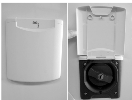
Fig. 99: Vandpåfyldningsstuds
