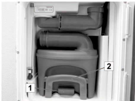
Fig. 192: Toilettank i tømmeskakten
