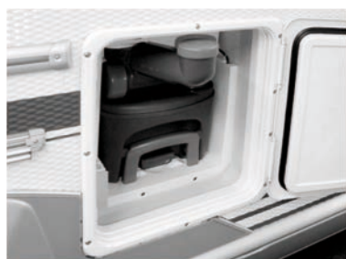
Fig. 47: Toilettank med skyllevand-påfyldningsstuds
