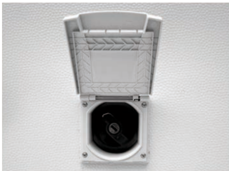
Fig. 88: Påfyldningsstuds for drikkevand
