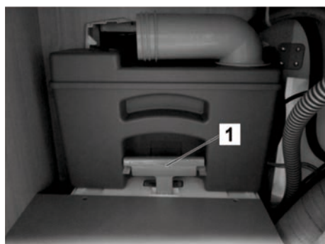
Fig. 195: Toilettank i tømmeskakten
