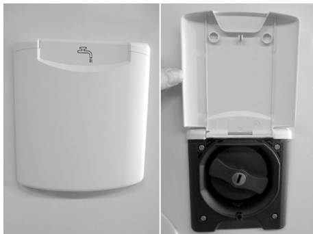
Fig. 22: Studs for påfyldning af drikkevand
