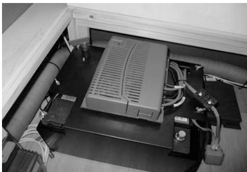
Fig. 60: Batteriafdækning med styreenhed til Mover (ekstraudstyr)
