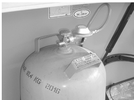
Fig. 108: Gasflaske med trykreduktionsventil
