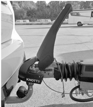
Afb. 13: Trekkogelkoppeling geopend, stabilisatie gedeactiveerd
