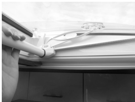
Afb. 127: Dakluik 400x400 mm / VisionStar 700x500 mm bedienen
