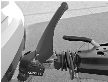
Afb. 9: Trekkogelkoppeling gesloten, stabilisatie gedeactiveerd
