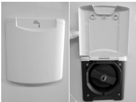
Bild 105: Påfyllningsstuts för färskvatten
