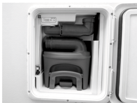
Bild 64: Fekalietank med påfyllningsstuts för spolvatten
