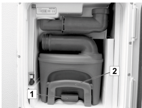
Bild 158: Fekalietank i avfallsschaktet
