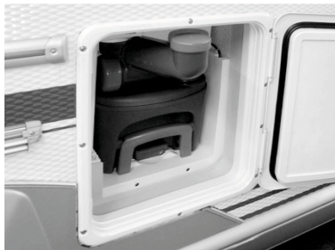
Fig. 52: Toilettank med skyllevand-påfyldningsstuds
