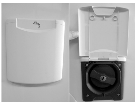
Fig. 27: Studs for påfyldning af drikkevand
