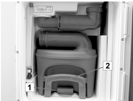
Bild 172: Fekalietank i avfallsschaktet
