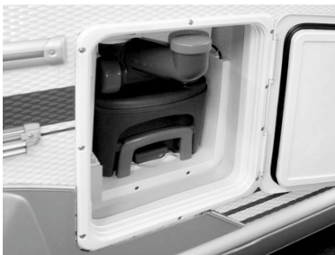
Bild 52: Fekalietank med påfyllningsstuts för spolvatten
