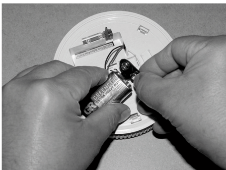
Bild 202: Byte av batteri
