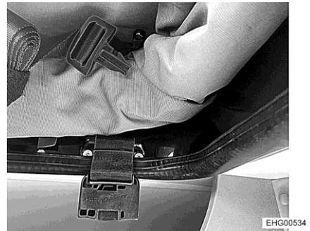
Fig. 58 Boucle de fermeture de sangle, ouverte
