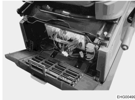
Fig. 65 Emplacement bloc électrique
