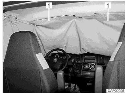
Fig. 20 Dispositif occultant de la cabine de conduite sur le pare-brise
