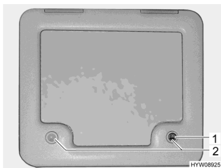
Bild 105 Lucka för latrintanken
